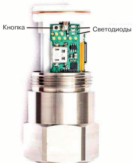
Рис. 18. Беспроводной датчик 8911 без защитной крышки
